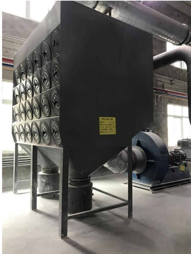
图 4.12 落料、包装等工序含尘废气处理设施设置情况图
