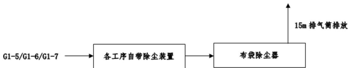
图 4.4 醇提橙皮苷含尘废气处理工艺流程图
